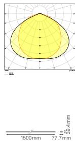
**Technische Daten Ledvance LED Tragschiene Trusys Flex Klar Stahl Weiß 70W 12100lm 120D - 840 Kaltweiß | 3 Stunden Notbeleuchtung**
