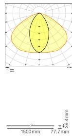
**Technische Daten Ledvance LED Tragschiene Trusys Flex Klar Stahl Weiß 50W 8600lm 60D - 840 Kaltweiß | 3 Stunden Notbeleuchtung**
